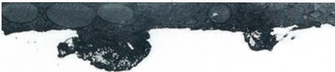
◀ Bild 1. Lochkorrosion auf einer CrNi-Stahl-Oberfläche (Probe ungeätzt)
