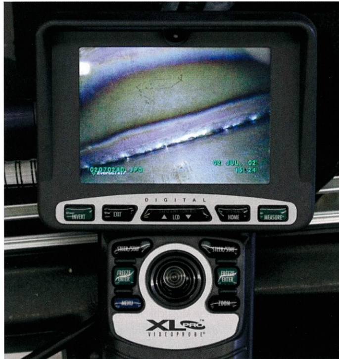
◀ Bild 8. Videorendoskopie einer Rohrrundnaht mit Anlauffarben (Bilder: [3, 4] (7), Killing)
