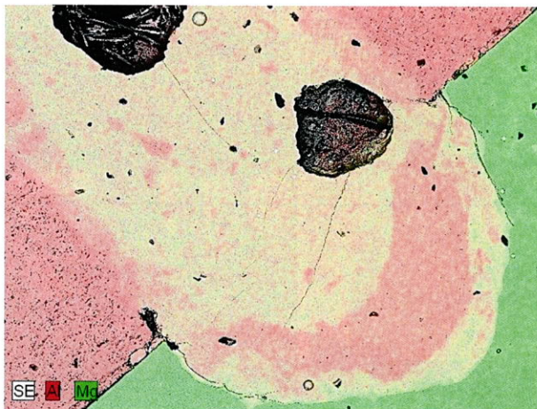
Bild 12 • REM-Aufnahme einer laserstrahlgewweißten Überlappverbindung eines Aluminiumblechs mit einem Magnesiumblech – EDX Mappingverfahren mit Elementverteilung von Aluminium und Magnesium im Fügebereich.
